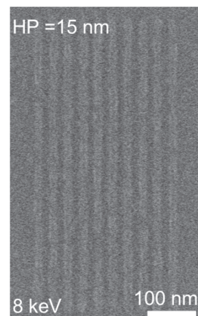
図 3. アニオンに SA を用いた場合の電子線描画後の SEM 画像
