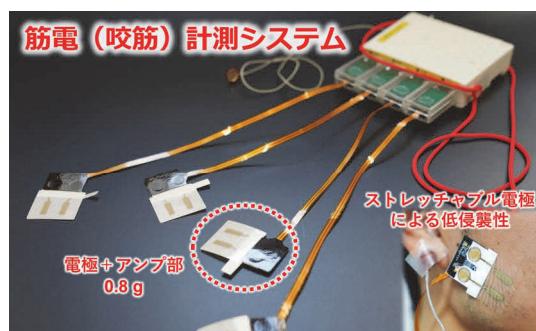
図1 筋電計測システムの概要
